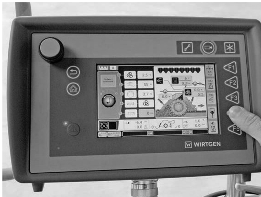
Slika 1092: Kontrolna tabla mašine za hladnu reciklažu sa svim relevantnim parametrima (Wirtgen, 2021)
